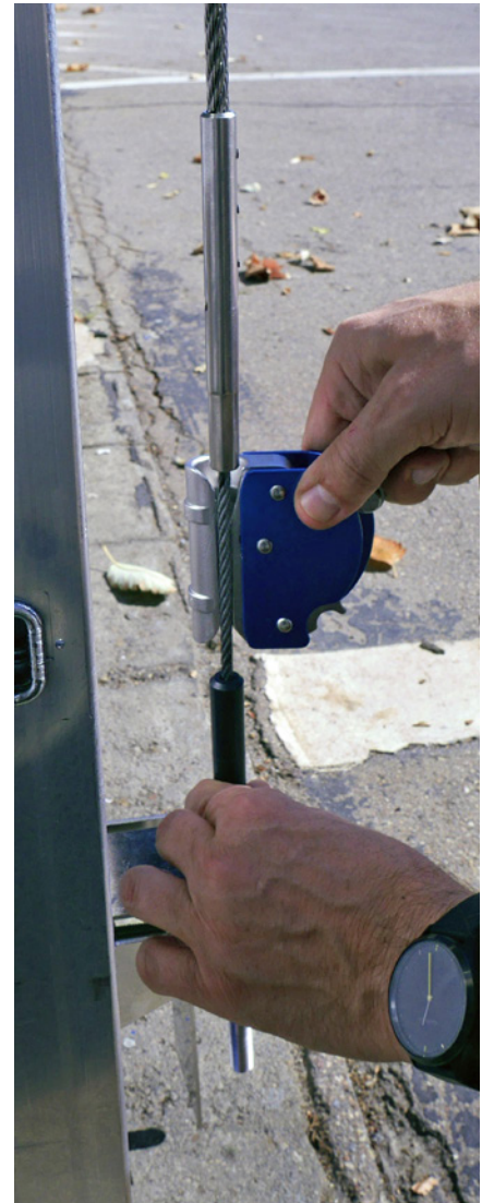
Das mobile Auffanggerät wird über einen Federverschluss eingehängt.
